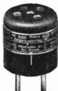
Nr. 01713 Drehbarer Pifco-Aufsteck-sockel zur Prüfung der Röhren auf Heizfadenbruch, Heizfaden-Gitterschluß, Heizfaden - Anodenschluß, Gitter-Anodenschluß . RM. 2,79
